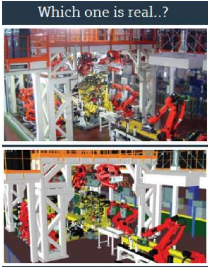
Il Digital Twin è sostanzialmente la possibilità di creare un ‘gemello digitale’ non solo del prodotto, ma anche di tutti processi legati alla produzione, quindi dall’idea, alla progettazione, pianificazione e ingegnerizzazione dei processi produttivi, fino alla produzione e alla connessione dei servizi.
